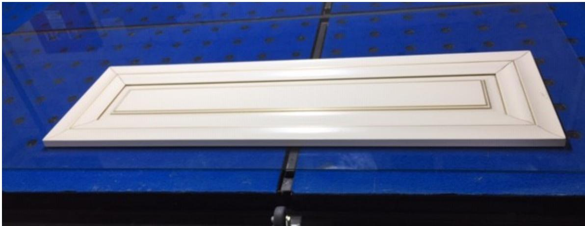
Произвести замер отклонения от плоскости поверенной металлической линейкой
